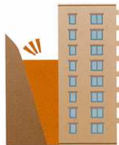
マンションと法面間の埋戻し
