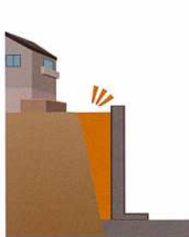
敷地と擁壁間の埋戻し
